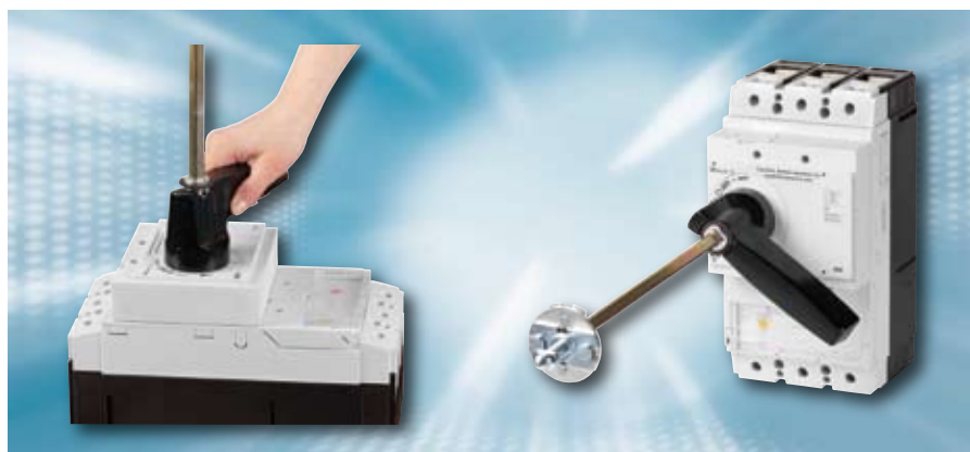
Figura 9: Con la maniglia più grande per gli interruttori di dimensioni NXM 3 e 4 è possibile applicare le forze d'azionamento richieste per questi interruttori. Anche per queste maniglie è richiesta l'azione intenzionale „Deliberate Action” consistente nel premere e girare le maniglie contemporaneamente entro un campo di rotazione predefinito.
